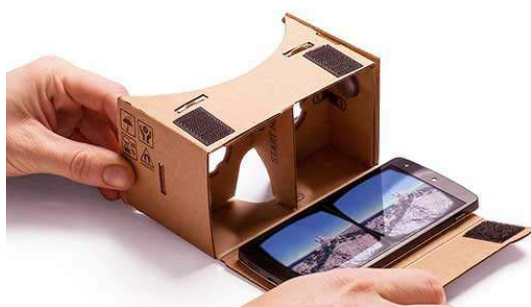
Fig 4: Imagen demostrativa del funcionamiento de las Google Cardboard. Fuente: Google
